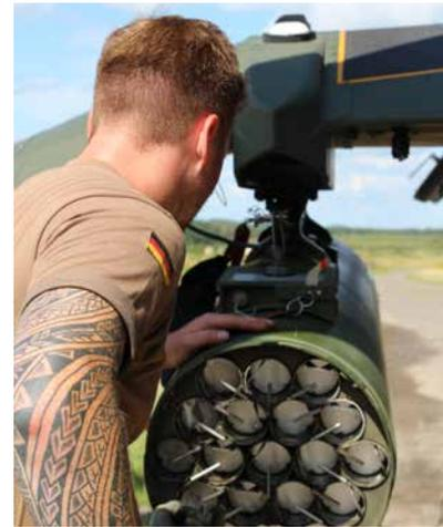
**Vorbereitung für das nächste Rennen: Aufmunitionieren der 70mm Raketen durch einen Fluggeräteunteroffizier Waffenelektronik.**
