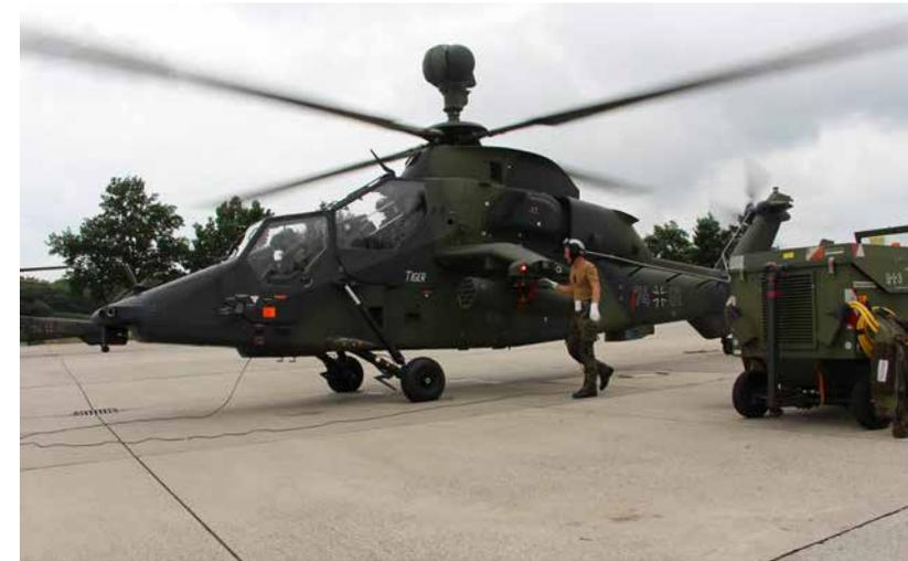
**Als letzte Maßnahme vor dem Abheben des Hubschraubers entfernt der TIGER-Mechaniker die Sicherungspins am Luftfahrzeug.**
